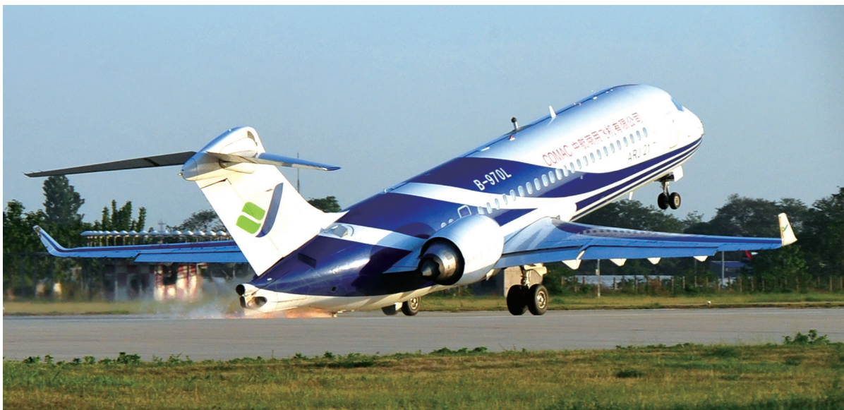
▲ ARJ21-700飞机最小离地速度局方审定试飞成功
