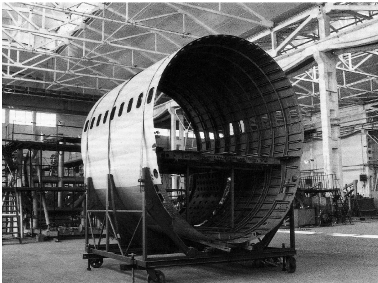
03段机身 运十飞机机身典型剖面采用倒“8”字的双圆弧状，交点线在地板处。上部设置客舱，下部设置货舱
